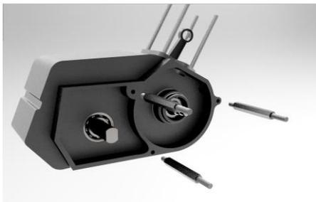
1.) 3x Abstandsbolzen M6x70 in Motorgehäuse eindrehen
