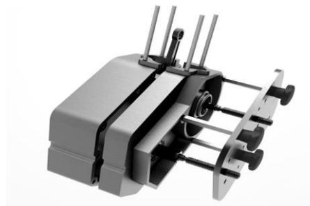
3.) Durch Eindrehen der beiden Druckbolzen M10 das Motorgehäuse trennen. (beiliegende T-Schlüssel verwenden)
